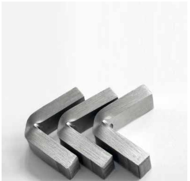
Provini della prova di resilienza (bonificati a 44 - 46 HRC) dopo la prova avvenuta su un pendolo da 450 J
