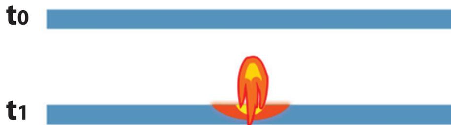
Nel punto in cui si va a saldare si ha un aumento veloce e localizzato della temperatura da cui ne consegue una dilatazione localizzata, infatti dilata solo l'acciaio scaldato e in proporzione alla temperatura raggiunta.
