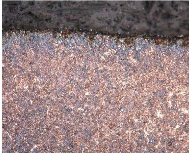
*Microstruttura di uno strato cementato acciaio 18NiCrMo5\_500X
